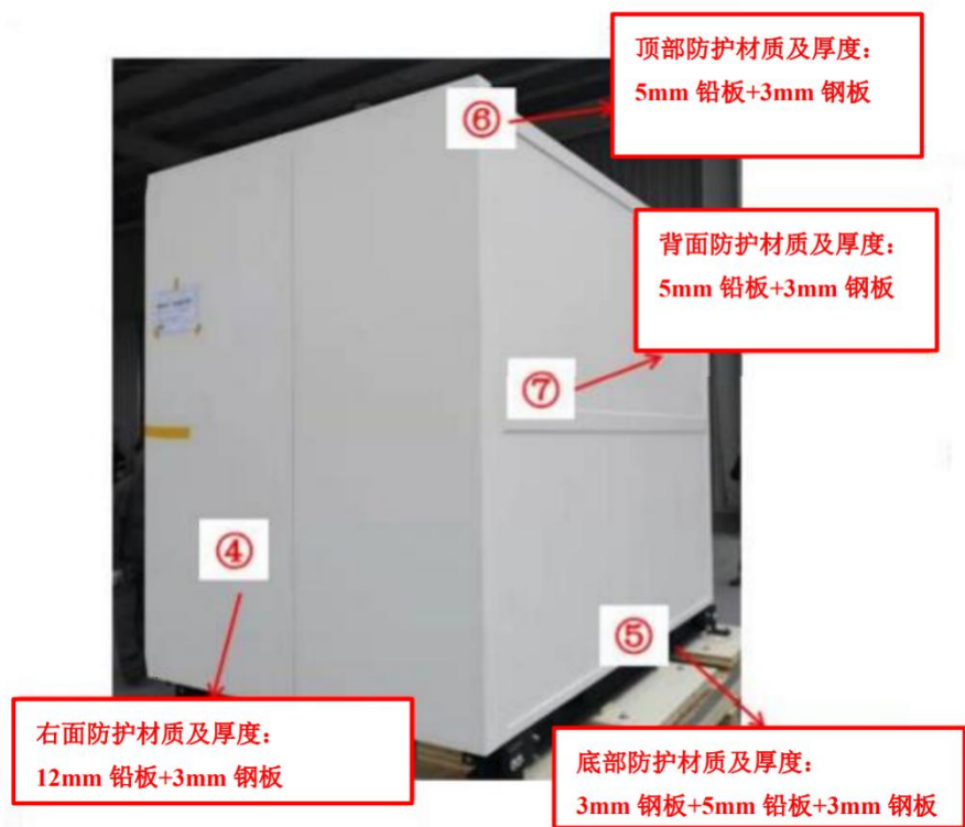
图 10-3 本项目工业 CT 屏蔽结构示意图
