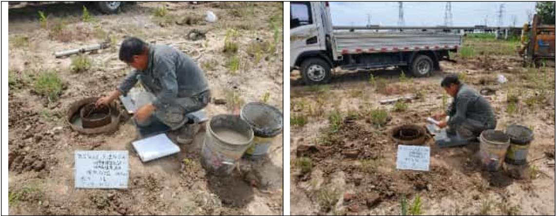
图 3.4-8 现场渗水试验照片
