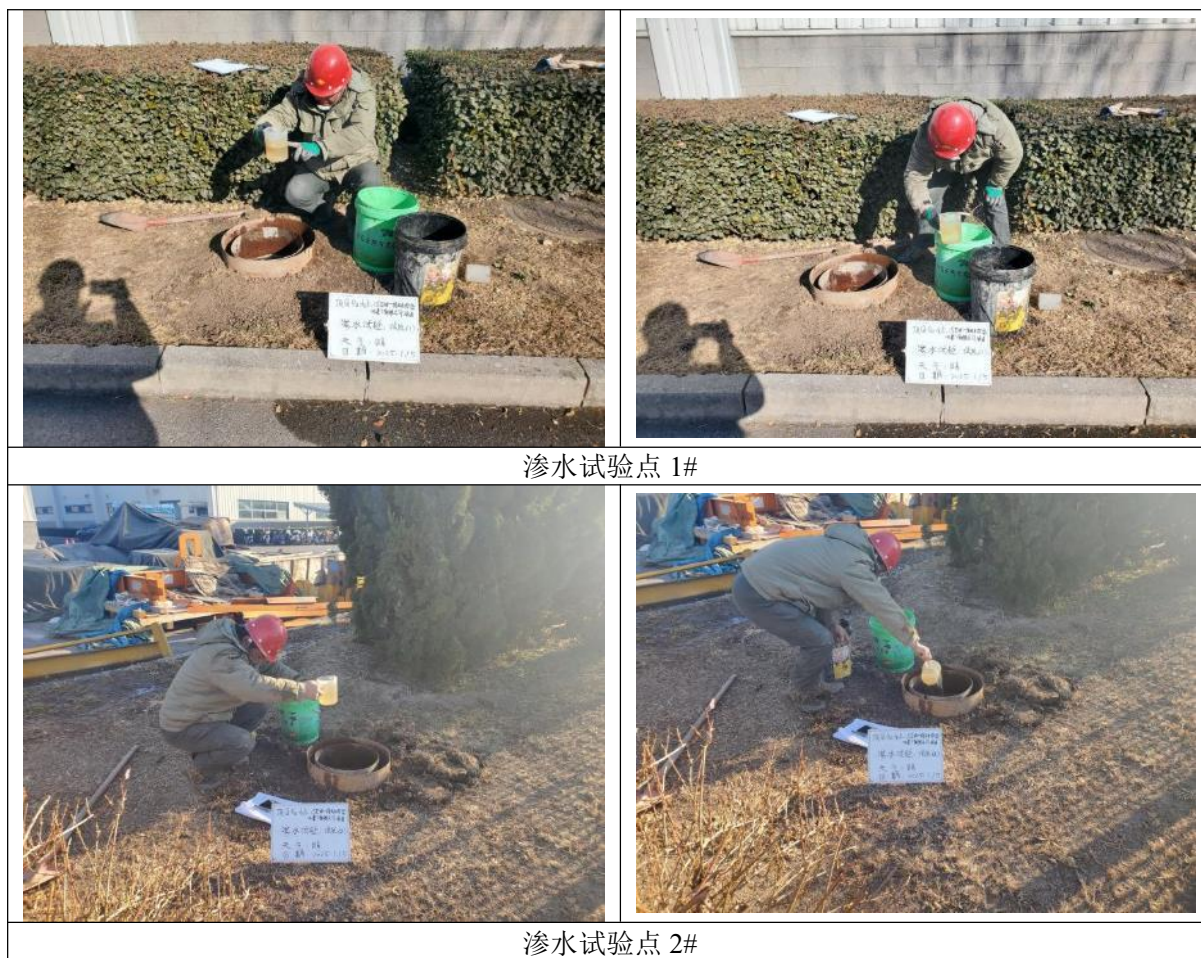
图 3.2-10 现场渗水试验照片
