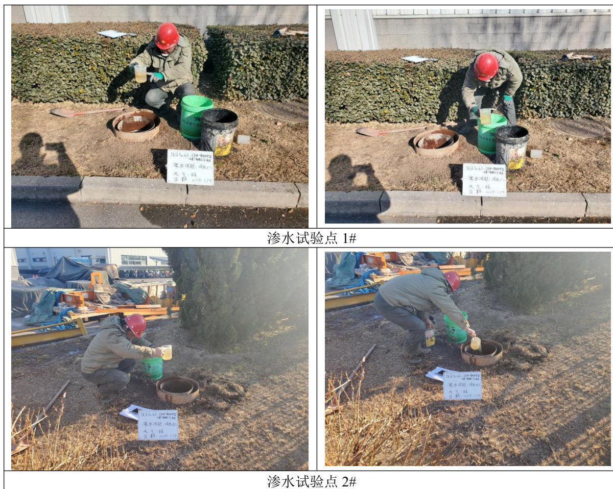
图 3.2-10 现场渗水试验照片
