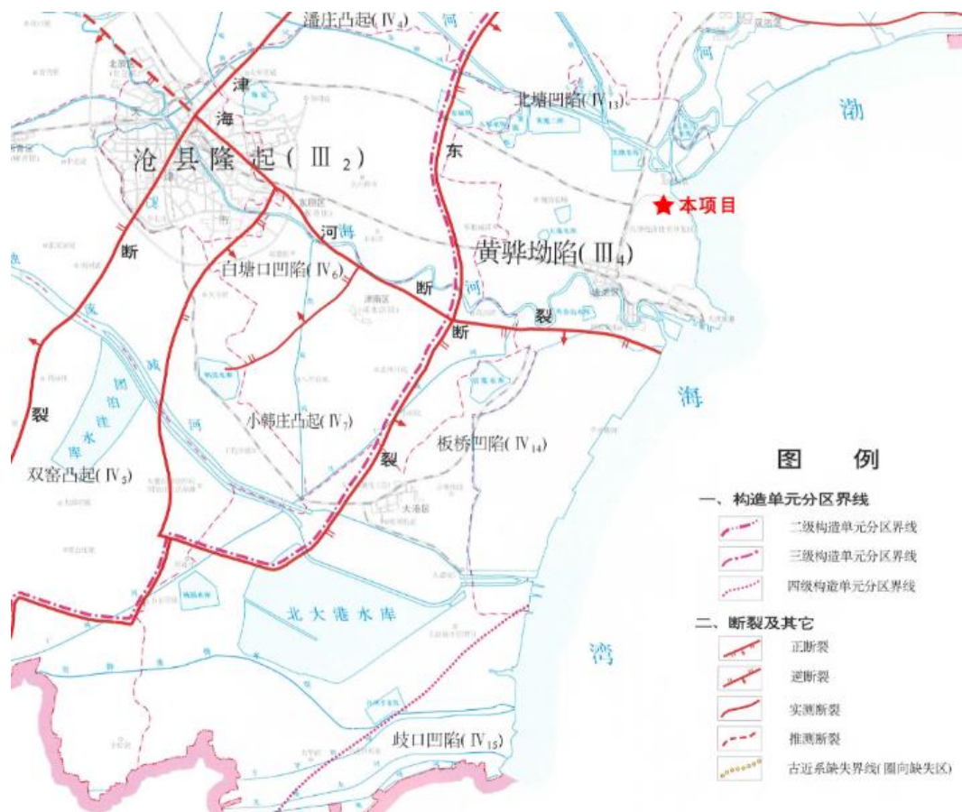
图 3.1-1 区域构造单元和断裂分布图
