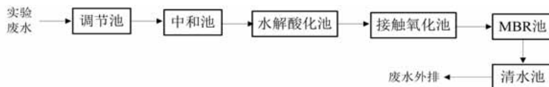
图 2.11-4 污水处理工艺流程示意图
