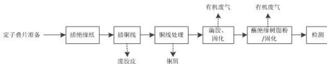
图 17 定子生产线生产工艺及产污环节
