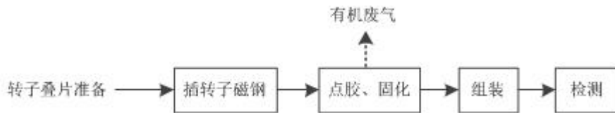
图 18 转子生产线生产工艺及产污环节
