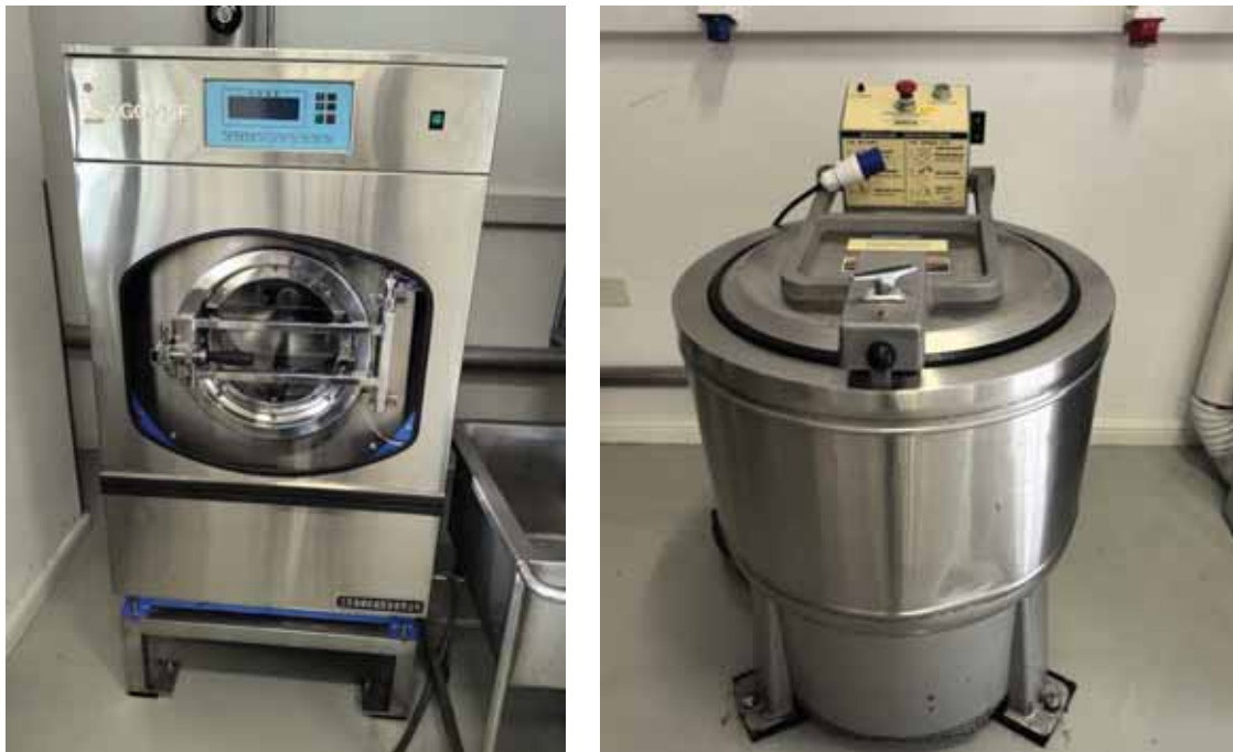
图3.2-2 工业水洗机和甩干机现场照片
