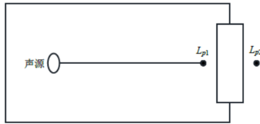
图7.3-1室内声源等效为室外声源图例
