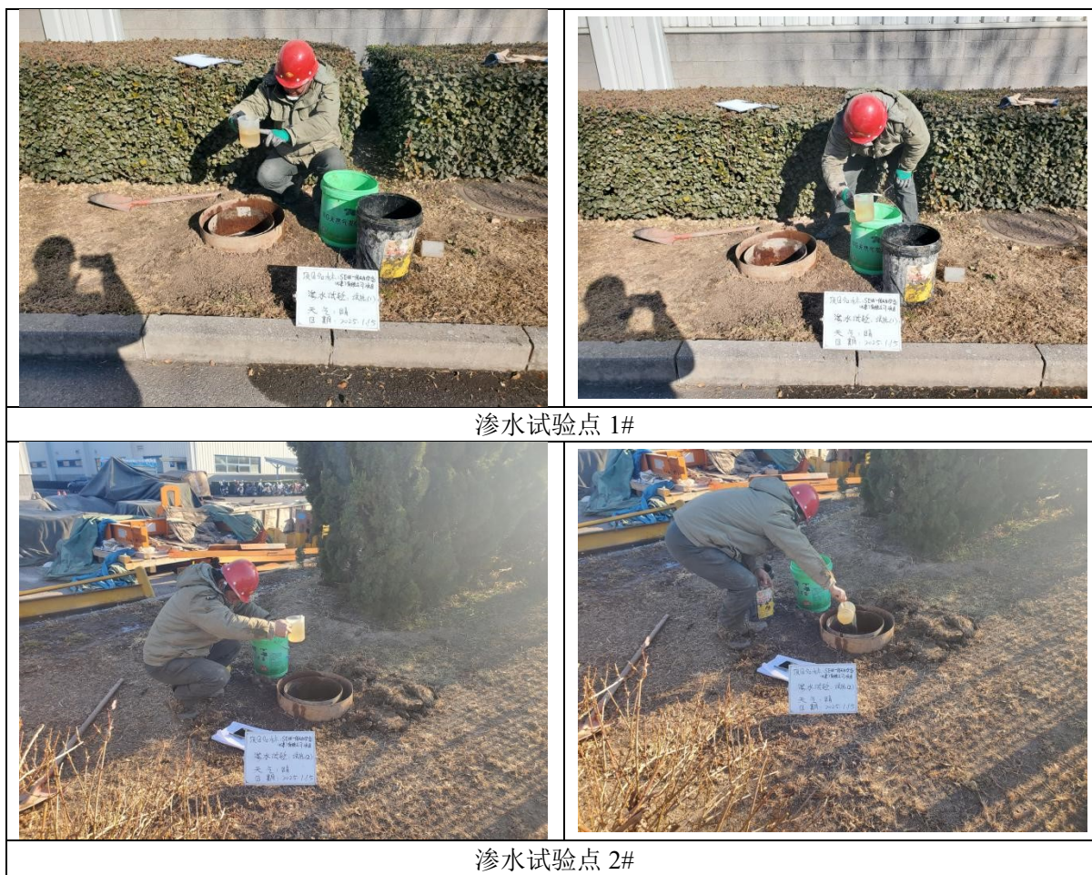
图 3.2-10 现场渗水试验照片
