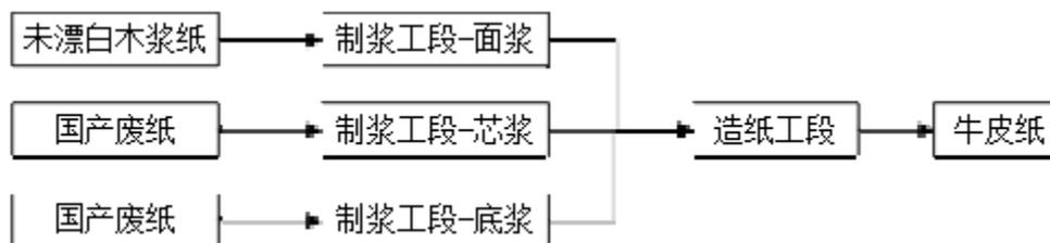
图 2.6-1 牛皮纸生产总体工艺流程图
