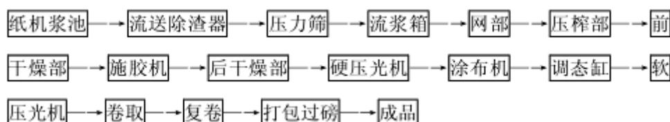
图 2.6-13 造纸工序工艺流程
