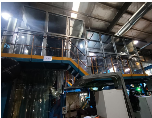
全钢工程子午胎车间复合机出料口集气罩
