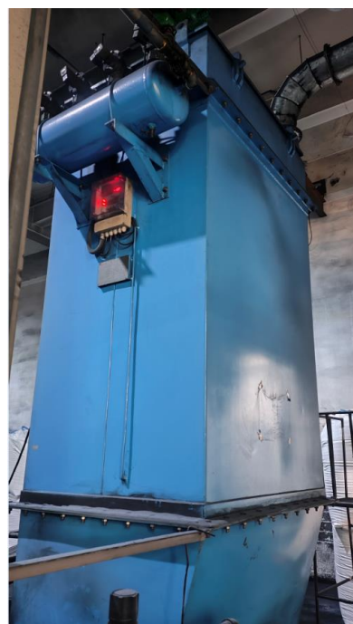
2#炭黑解包废气除尘器
