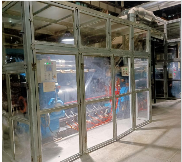
农业子午胎和斜胶工程胎车间压延机密闭围罩
