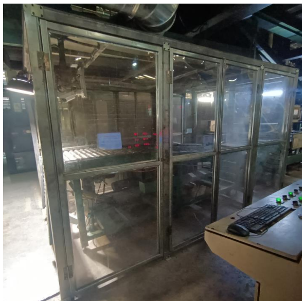
全钢工程子午胎车间胶料传送密闭围罩
