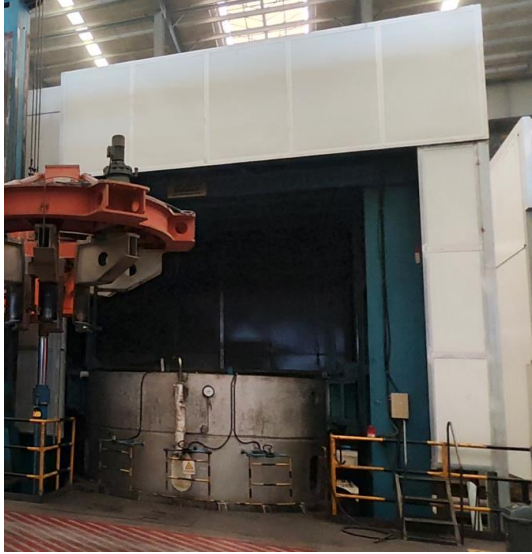
全钢工程子午胎车间硫化机设置收集罩，卷帘门可关闭
