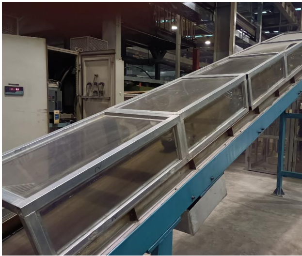
农业子午胎和斜胶工程胎车间挤出机胶料传送围罩
