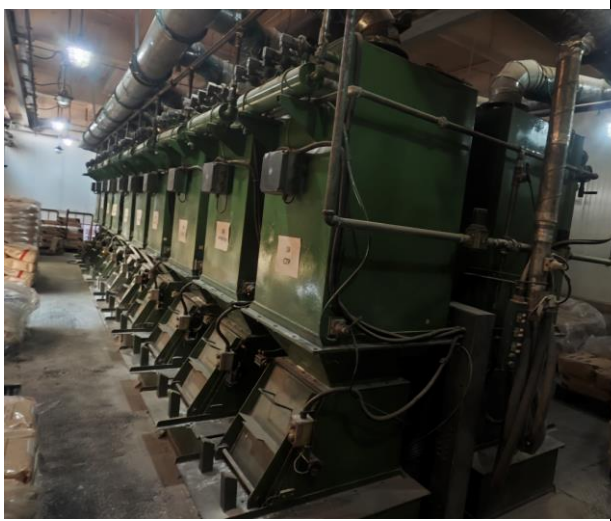
3#小粉料解包、配料配套的除尘器
