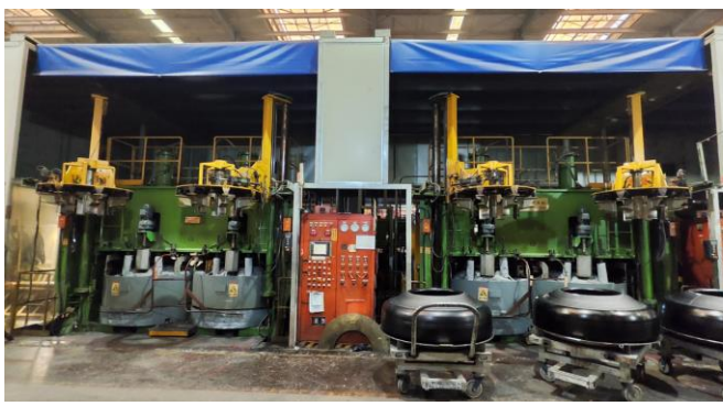
农业子午胎和斜胶工程胎车间硫化机设置收集罩，卷帘门可关闭
