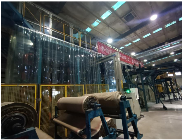
农业子午胎和斜胶工程胎车间压延生产线整体围罩
