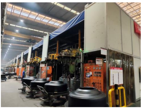
农业子午胎和斜胶工程胎车间硫化机设置收集罩，卷帘门可关闭
