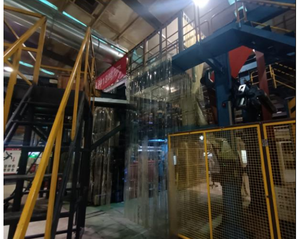
农业子午胎和斜胶工程胎车间四辊压延机废气收集围罩
