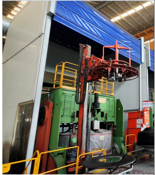
全钢工程子午胎车间硫化机设置收集罩，卷帘门可关闭
