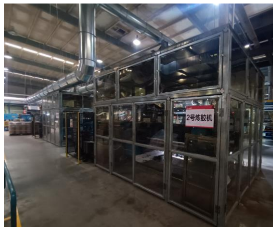
全钢工程子午胎车间胶料传送密闭围罩
