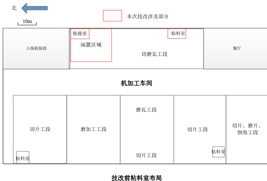
图1 本项目技改前机加工车间粘料室布局示意图
