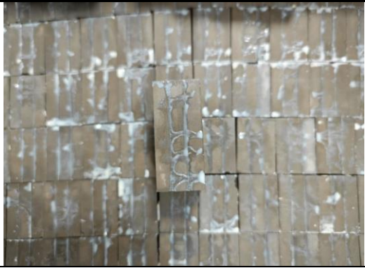
粘接后的钕铁硼磁铁毛坯示例
