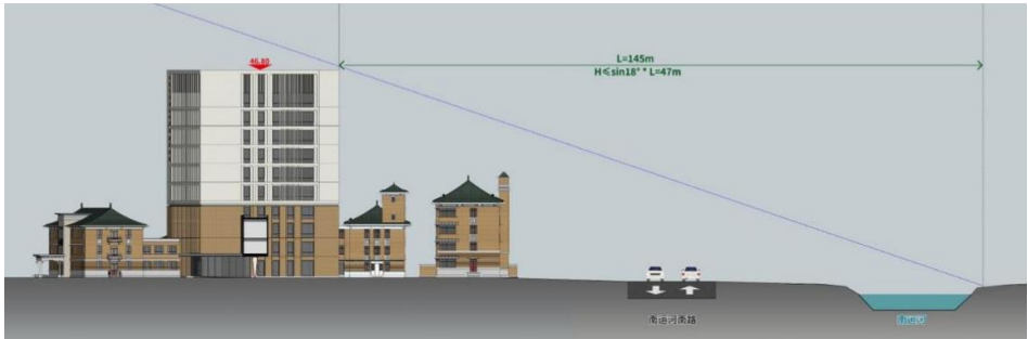
图 1-2 本项目建筑高度与运河关系剖面
